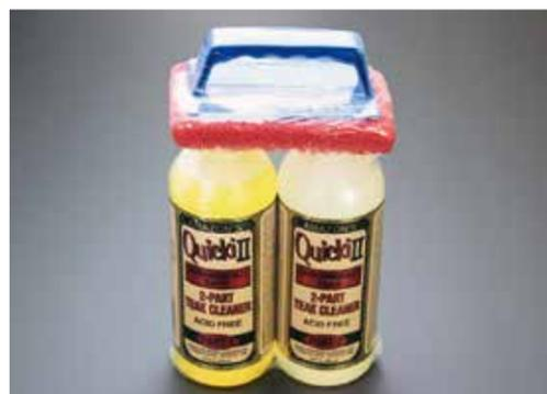
チークを濡らし、PART-1を付属のスクラバーを使用し塗布します。汚れが浮き出てきたら清水でリンスします。次にPART-2でブラシがけして、中和させ光沢を出します。
