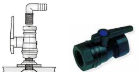
Forespar の MF850 シリーズボールバルブは、高精度、高強度 Marelon® で成形されています。腐食や電気分解の心配がなく、喫水線の上下に使用可能な理想的なバルブです。バルブの耐久テストでは、11,000 回バルブを開閉、その後水に沈め、40PSI に加圧された空気ラインに接続しました。結果は内部シールの摩耗は無く、もれも発生しませんでした。米国で販売されるマリン用バルブは並行ネジです。ヨーロッパで一般的に使用される BSP 規格については、お問い合わせください。
