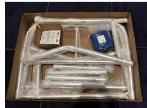
主要部分は溶接されています。 輸送のために分割されています。パイプ内側にスリーブをいれて、エポキシで接続して組み立てます。(エポキシ接着は約 540kg の接着力があります。)
