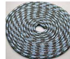
黒色にブルーのフレック入りポリエステルダブルブレイドロープ。内側は8打ちで外側は16打ち、ソフトで非常に使いやすい。黒色原着糸・耐紫外線。※ポートサイズはアンカーロープとして使用する場合があります。
