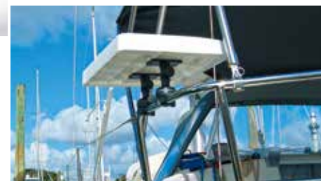
スターポートをパイプにマウントして、テーブルを取り付けた様子です。
