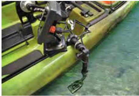
ボディーに別途サイドマウントを取り付けて使用しています。
