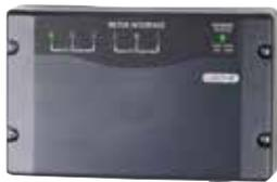
外部の AC / DC の電力計測センサーからの入力を受け AD 変換。デジタル文字列に変換します。AC と DC 電圧と電流、AC kW、バッテリーの残量 (A / 時間 & バッテリーの残量%) を計算することができます。
