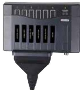
従来のサーキットブレーカとヒューズパネルの代替となります。6 回路 × 20A 回路の電子ブレーカーとバックアップヒューズ、タイマーや調光器 (ディマー) などの組み込みが可能です。負荷近くに回路の制御と保護を移動することで電気配線の長さを減少させ、電線の径サイズを細くすることができます。
