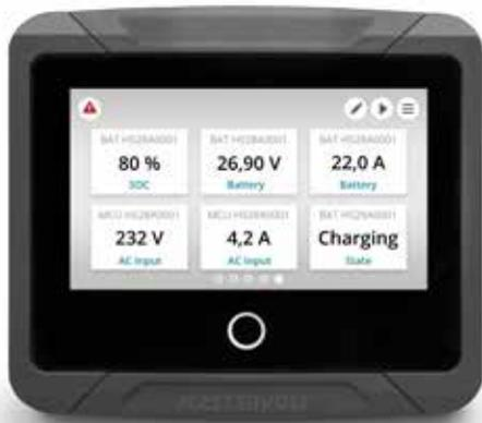
4.3 インチのタッチパネルスクリーンを搭載した「イージービュー」は、小型ながら MasterBus に接続された機器のステータス表示だけでなく、スイッチインターフェースに接続された機器類のオンオフもコントロールできます。
