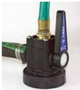
ガーデンホース(3/4" GHT) ネジ規格とは、外径約19mm, 1インチに10山のネジです。ユニファイの粗目ネジ、ネジ山角度 60 度
