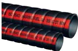
燃料給油用ホースはスパイラルにワイヤーが入っていて小さな曲げ半径でも潰れません。ガソリン・軽油配管に使用できます。meet SAE1527,ISO7840,Marine Fuel A2 耐圧：4 bar
