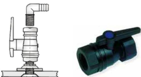
Forespar の MF850 シリーズボールバルブは、高精度、高強度 Marelon® で成形されています。腐食や電気分解の心配がなく、喫水線の上下に使用可能な理想的なバルブです。バルブの耐久テストでは、11,000 回バルブを開閉、その後水に沈め、40PSI に加圧された空気ラインに接続しました。結果は内部シールの摩耗は無く、もれも発生しませんでした。米国で販売されるマリン用バルブは並行ネジです。ヨーロッパで一般的に使用される BSP 規格については、お問い合わせください。
