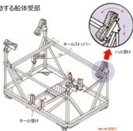
各柱の上端の取り付けられた船体受部は、揺動自在で上下にも位置調整可能です。船体形状に関係なく、ヨットを優しく支えます。船体位置決めストッパーは、前後方向に調整可能。また船体キール受けは前後だけでなく、上下にも位置調整できます。
